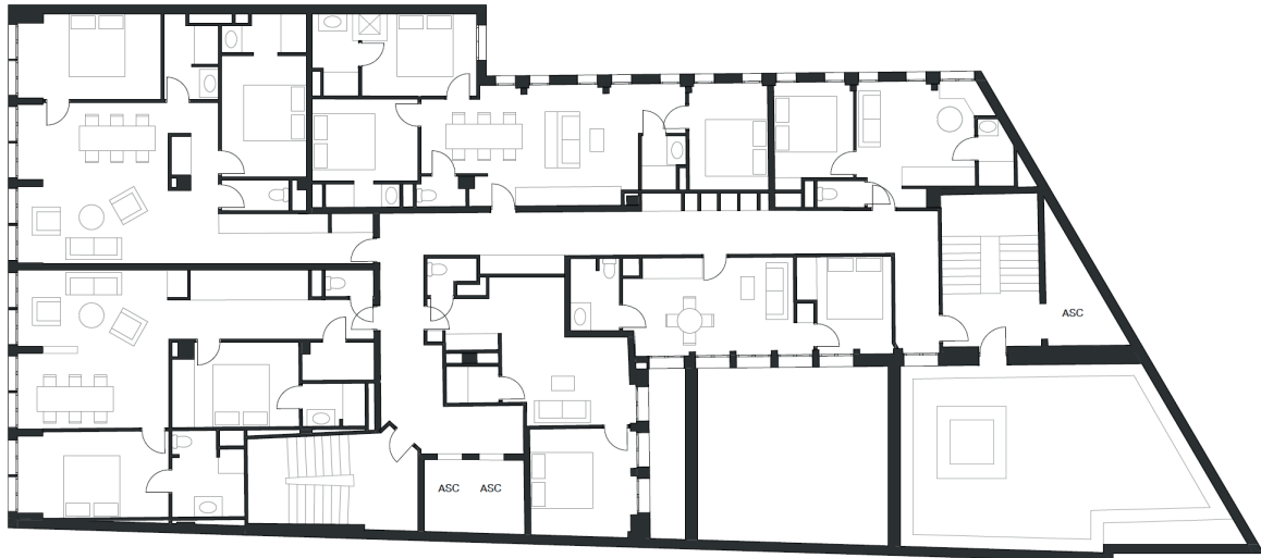
Organisation des pièces selon la trame d'origine. Plan du 2e étage de la résidence du Hameau, Paris 15e. Document autographe.
